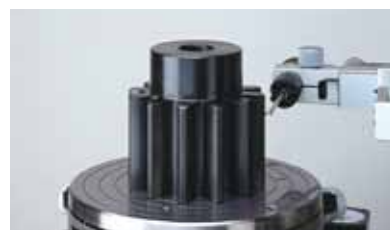
Medición en pieza con discontinuidades
