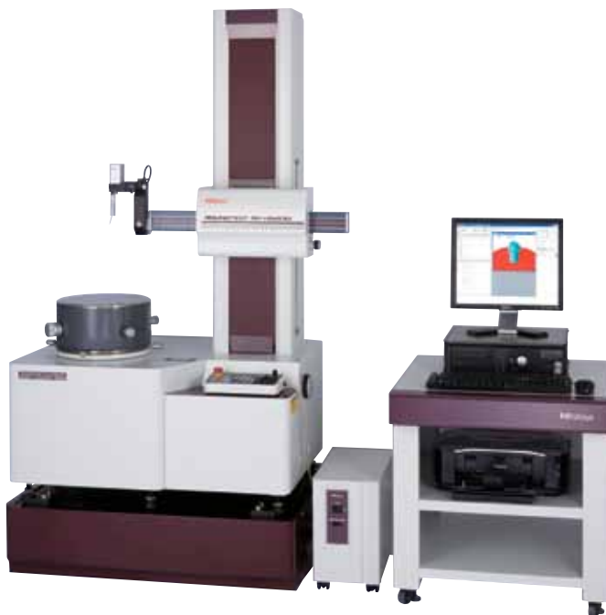
RA-H5200 CNC con sistema de computadora personal y software
