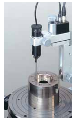
Medición dentro de diámetro interior
