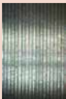
Paso de la cuerda de la rosca del tornillo= 0.1mm
