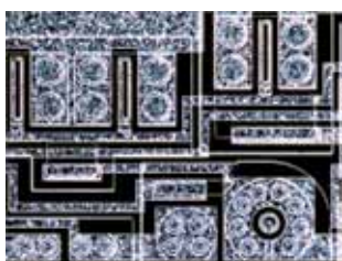
Observación con campo oscuro (DF): Observando sólo la luz dispersa apagando la luz directa a los objetivos. Las rayaduras y polvo que no pueden ser vistas con campo se pueden observar mediante un alto contraste.
