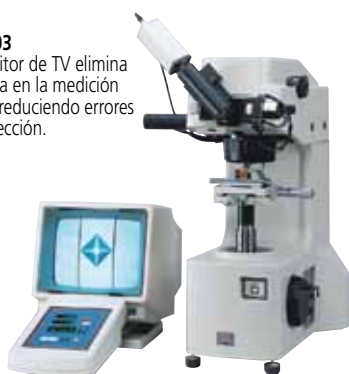
HM-113 Reduce diferencias individuales en medición visual con el monitor de TV. La función de cálculos estadísticos reduce el tiempo de operación.
