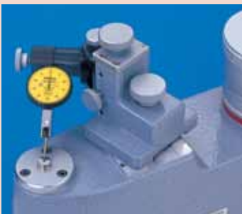
Calibrando un indicador de carátula tipo palanca
