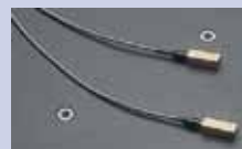
Sistema de compensación por temperatura (foto: sensores de temperatura)
